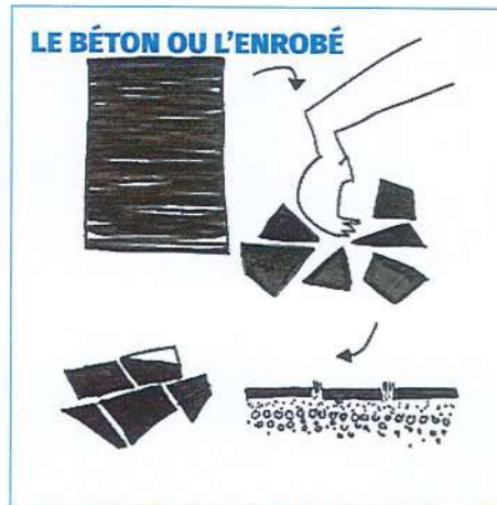
Réemploi d'enrobé ou de dalles béton en revêtements
